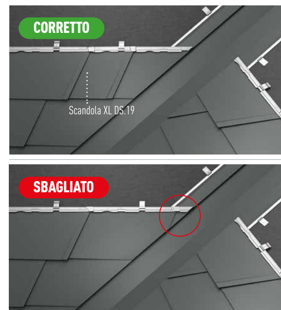
Figura 63 • Compluvio – Specifica con scandole DS.19
