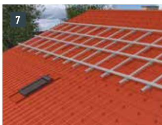
Figura 65 • Sistema a montaggio ultimato (posa a croce in presenza di carichi elevati)
