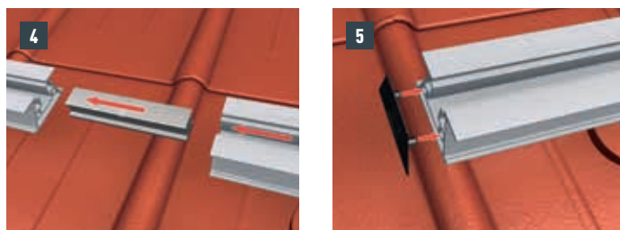
Figura 63 • Fissaggio del sistema di montaggio per pannelli solari
