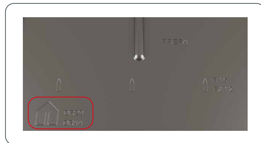
Figura 61 • Grondalina di partenza - Marcature per la scaglia per facciata 29 × 29 e la scaglia per facciata 44 × 44
