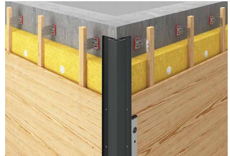
Figura 67 • Posa angolare esterno profilo ripiegato – piccolo formato PREFA
