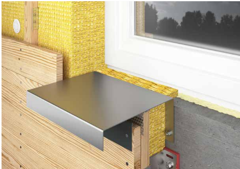
Figura 73 • Montaggio del nastro forato e del lamierino di tenuta
