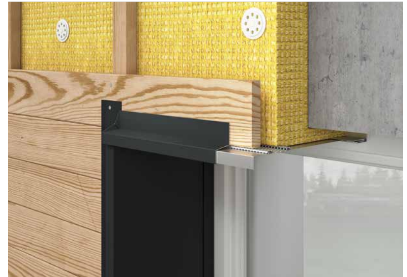
Figura 82 • Montaggio del gocciolatoio dell'architrave della finestra
