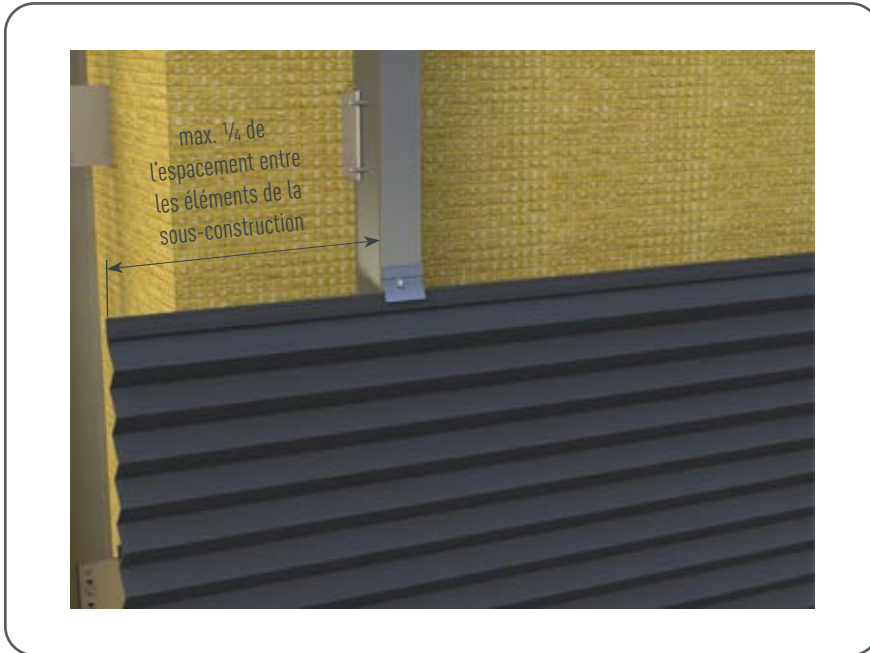
Figure 3 • Dépassement maximal des profils extrudés
