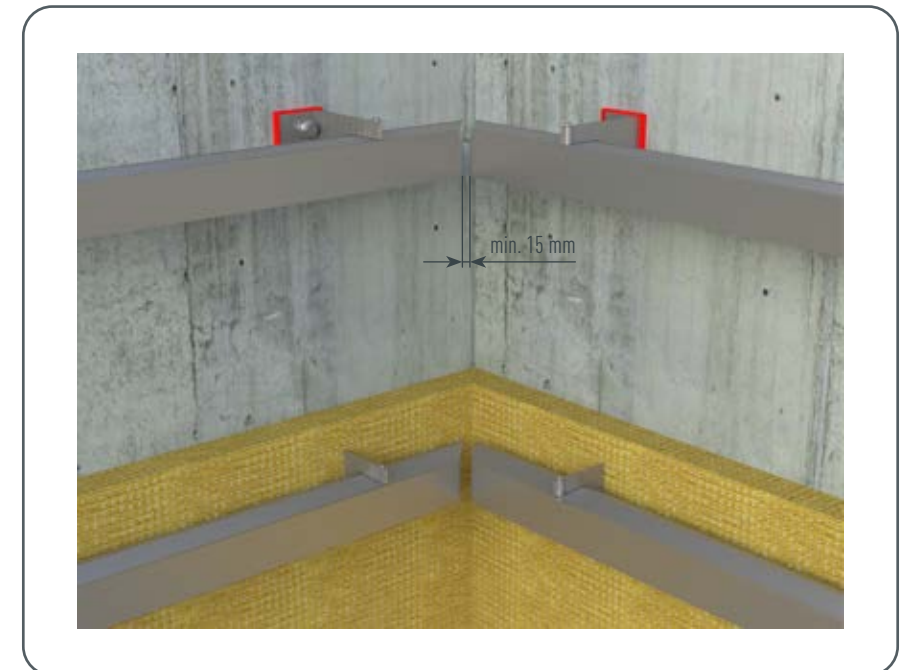
Figure 53 • Jeu de dilatation entre les profils porteurs
