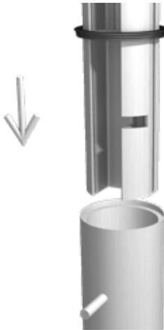
**17** Darauf achten, dass die Dichtung vollflächig und satt aufliegt. Das Rundprofil im Uhrzeigersinn verdrehen, bis die Öffnungen in Richtung der Grund- oder U-Profile zeigen.
