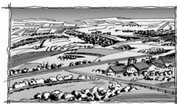
Catégorie de terrain II – Zone à végétation basse telle que de l'herbe, avec quelques obstacles isolés (arbres, bâtiments) séparés les uns des autres d'au moins 20 fois leur hauteur.
