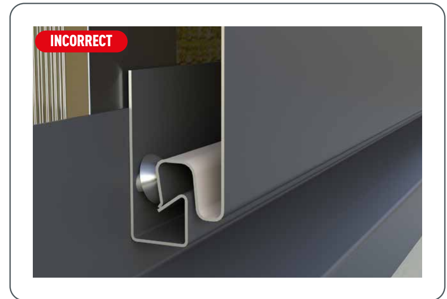
Figure 77 • Fixation incorrecte du profil de départ
