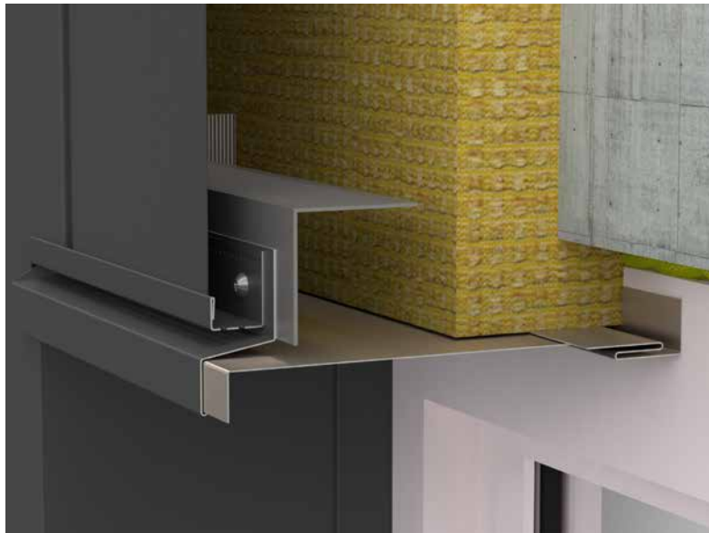
Figure 103 • Linteau de fenêtre
