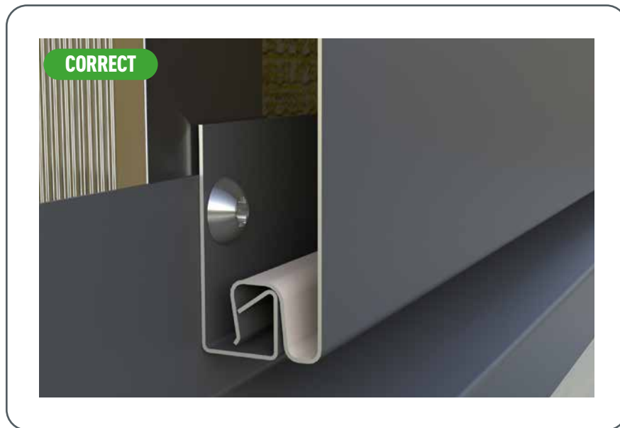
Figure 76 • Fixation correcte du profil de départ
