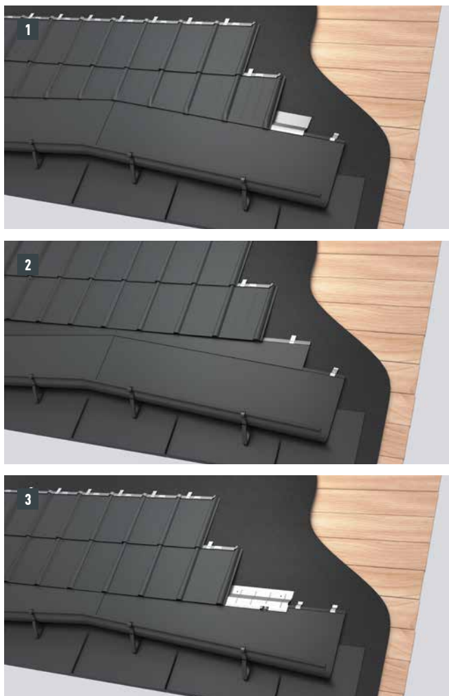
Figure 76 • Raccordement à une gouttière havraise
