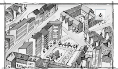
Fig. 6: Catégorie de terrain IV — Zone dont au moins 15 % de la surface sont recouverts de bâtiments dont la hauteur moyenne est supérieure à 15 m.
