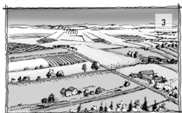
Fig. 3: Catégorie de terrain I — Lacs, plans d'eau et zone plate et horizontale à végétation négligeable et libre de tous obstacles.
