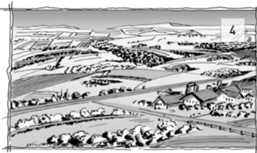
Fig. 4: Catégorie de terrain II — Zone à végétation basse telle que de l'herbe, avec ou non quelques obstacles isolés (arbres, bâtiments) séparés les uns des autres d'au moins 20 fois leur hauteur.
