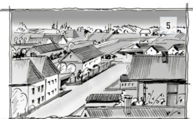
Fig. 5: Catégorie de terrain III — Zone avec une couverture végétale régulière ou des bâtiments, ou avec des obstacles isolés séparés d'au plus 20 fois leur hauteur (par exemple des villages, des zones suburbaines, des forêts permanentes).
