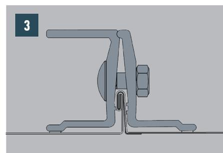
3 Le sens de pose du support doit être choisi de manière à ce que la tige filetée puisse ensuite être posée côté agrafe.
