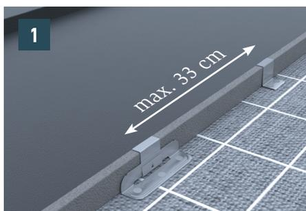
1 Dans la zone de pose des modules (cf. Fig. 7), il ne faut en aucun cas dépasser l'espacement maximal de 33 cm entre les pattes (centre à centre).
