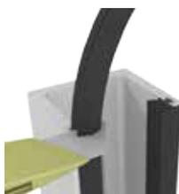
Les profils en U doivent également être parfaitement étanches à l'eau au niveau du sol.
