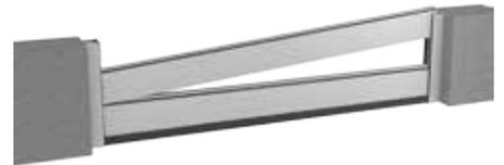
34 Veiller à ce que les batardeaux soient parfaitement centrés, afin que les intervalles à l'intérieur des profils soient de longueur identique des deux côtés.
