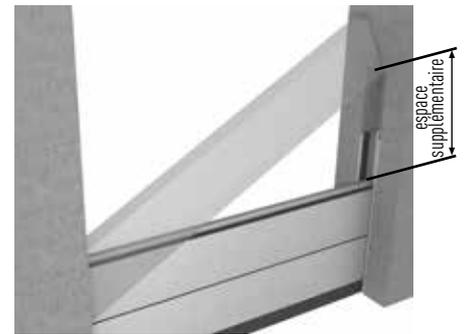
**23** Veiller à ce que les batardeaux soient parfaitement centrés, afin que les intervalles à l'intérieur des profils soient de longueur identique des deux côtés.
