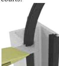
Les profils en applique doivent également être parfaitement étanches à l'eau au niveau du sol.
