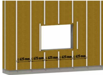
Um in der Hinterlüftungsebene einen ungehinderten Strömungsverlauf zu gewährleisten, ist darauf zu achten, dass die Tragprofile ausschließlich vertikal ausgerichtet montiert werden.
