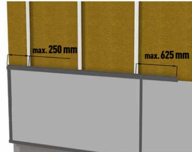
Der Hinterlüftungsspalt soll einen Abstand von 20–30 mm betragen und bemisst sich von der Vorderseite der Wärmedämmung bis hin zur Rückseite der H-Profile.
