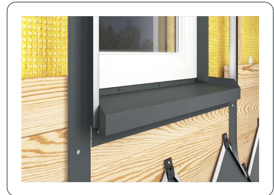
Abbildung 76 • Montage Haltewinkel Fensterlaibung
