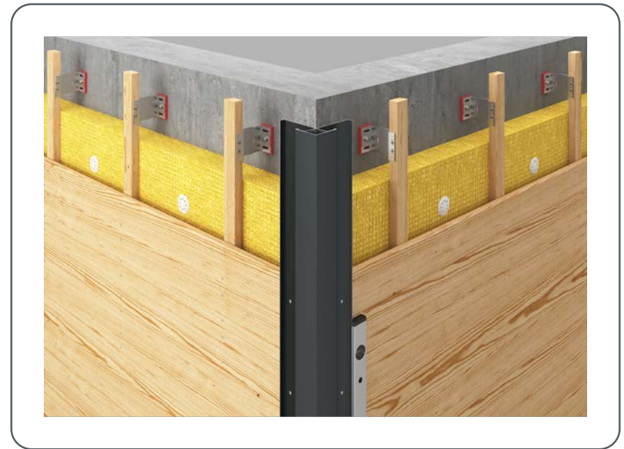
Abbildung 67 • Außenecke Montage Taschenprofil – PREFA Kleinformat
