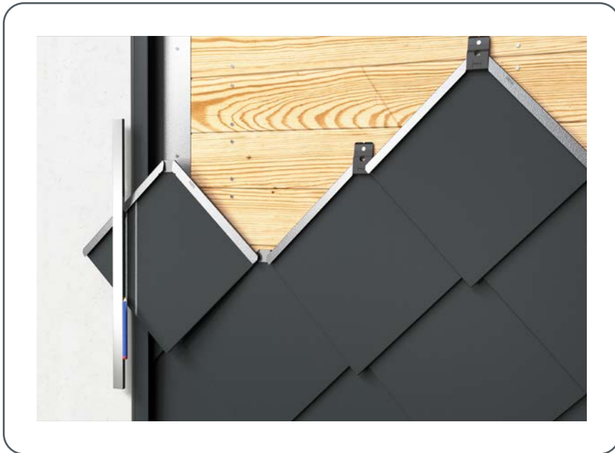
Abbildung 70 • Seitlicher Anschluss - Hochkantung
