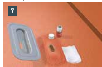
7 Angeschliffene Klebestellen mit Haftreiner reinigen.
