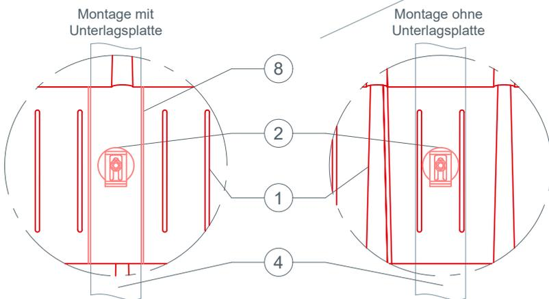
Bei kleinformatigen PREFA Dachelementen kann es erforderlich sein eine Unterlagsplatte einzubauen, um den PREFA Solarhalter Vario oder Fix zu montieren (zb. wenn ein Falz im Montagebereich über dem Sparren liegt)
