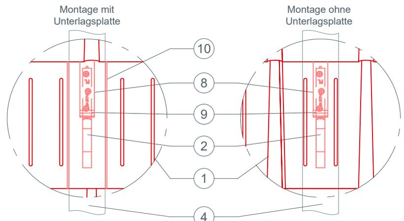
Bei kleinformatigen PREFA Dachelementen kann es erforderlich sein eine Unterlagsplatte einzubauen, um den PREFA Dachsicherheitshaken zu montieren (zb. wenn ein Falz im Montagebereich über dem Sparren liegt)
