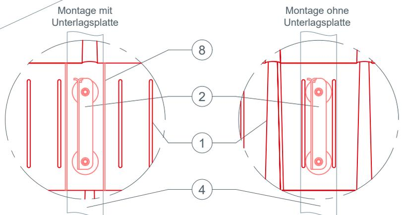
Bei kleinformatigen PREFA Dachelementen kann es erforderlich sein eine Unterlagsplatte einzubauen, um die PREFA Gebirgsschneefang Stütze zu montieren (zb. wenn ein Falz im Montagebereich über dem Sparren liegt)
