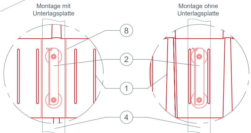
Bei kleinformatigen PREFA Dachelementen kann es erforderlich sein eine Unterlagsplatte einzubauen, um das PREFA Schneerechensystem zu montieren (z.B. wenn ein Falz im Montagebereich über dem Sparren liegt)
