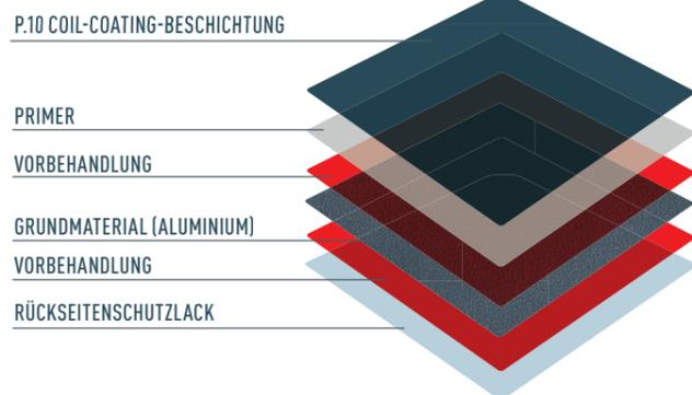
Mit P.10 hat PREFA eine farbbeständige Oberfläche entwickelt, die auch höchsten Qualitätsanforderungen entspricht. Das Material widersteht äusseren Einflüssen sowie Belastungen und ist UV-, farb- und witterungsbeständig. Gleichzeitig ist Aluminium ein unglaublich leichter und stabiler Werkstoff, der sehr viele Möglichkeiten bei der Planung und Ausführung bietet.
