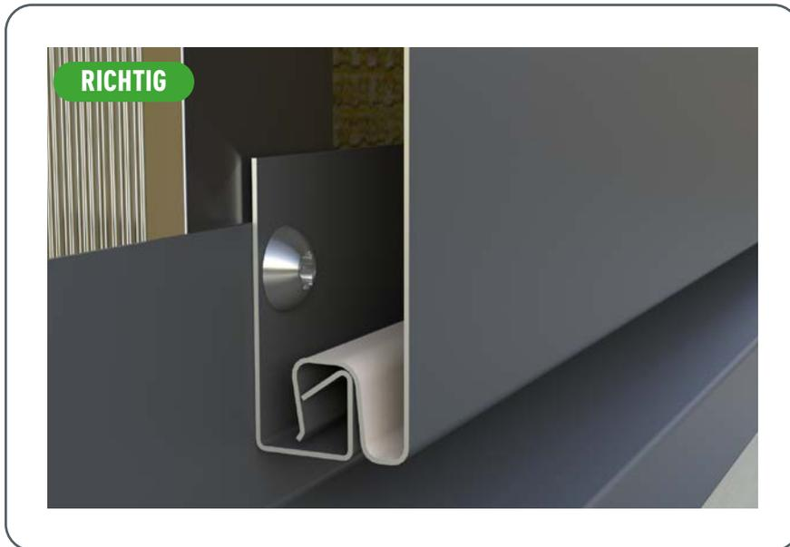
Abbildung 76 • Befestigung Startprofil in Ordnung
