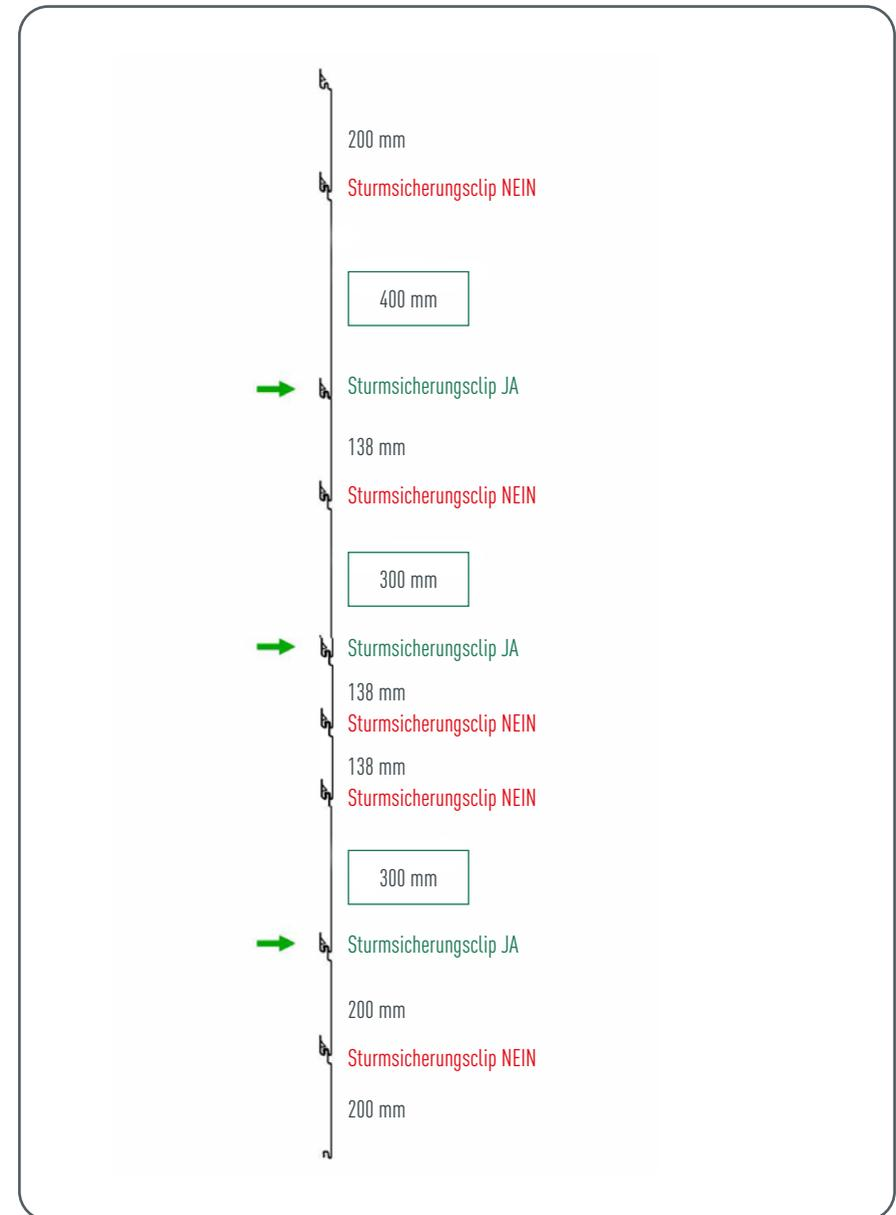
Abbildung 62 • Sturmsicherungsclip Siding.X
