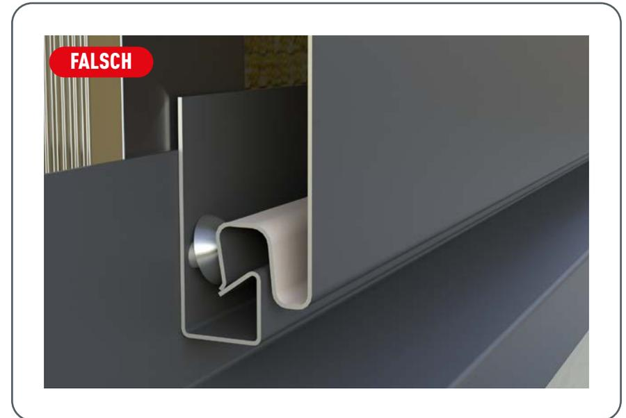
Abbildung 77 • Befestigung Startprofil nicht in Ordnung
