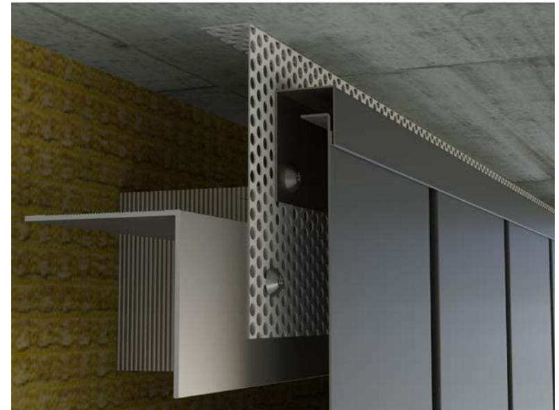
Abbildung 88 • Oberer Abschluss Siding vertikal
