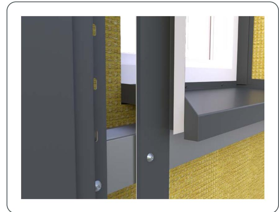
Abbildung 96 • Montage Haltwinkel Fensterlaibung
