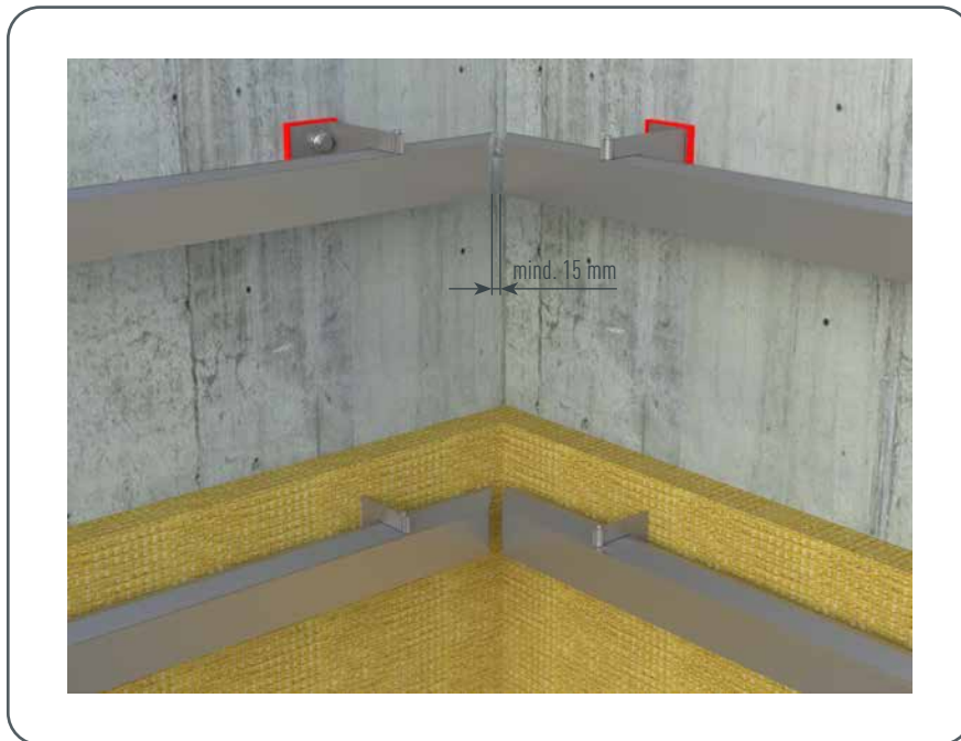
Abbildung 49 • Dehnungsabstand zwischen Tragprofilen
