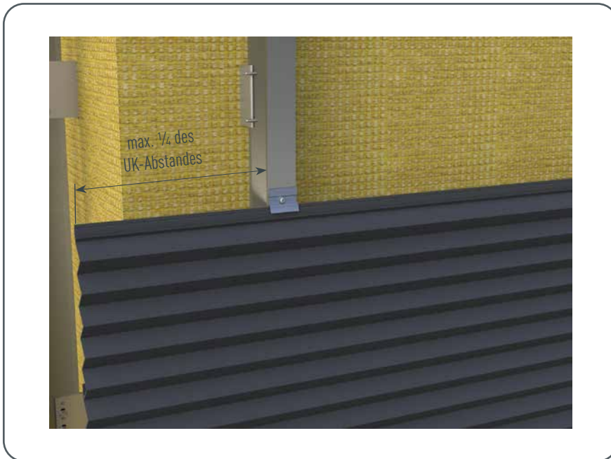
Abbildung 3 · Max. Auskragung der Strangpressprofile
