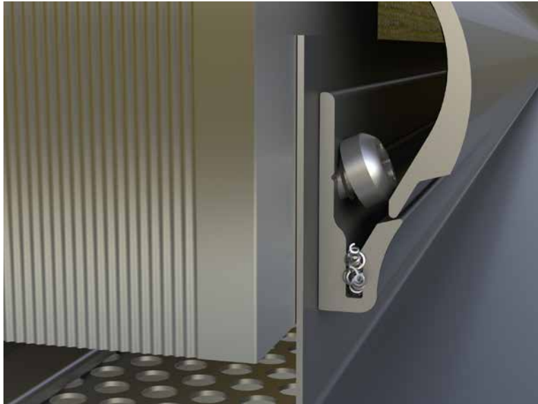
Abbildung 32 • Fehlerhafte Befestigung Startprofil
